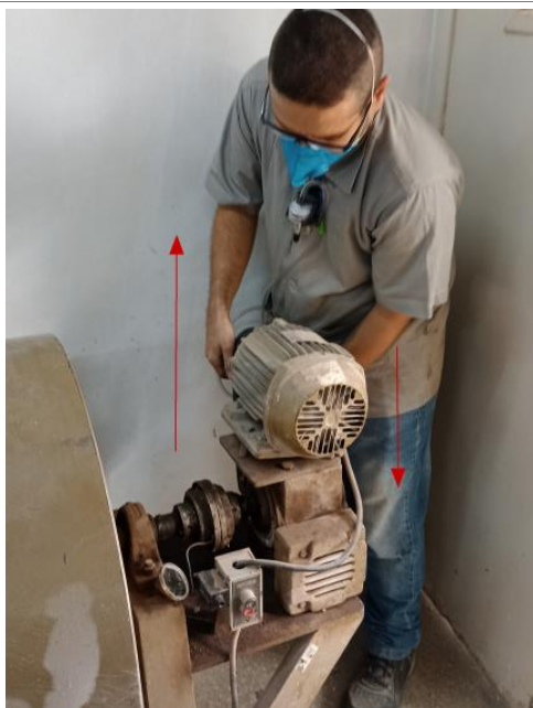
Imagem 07 – Movimentação da correia do motor do cilindro.
